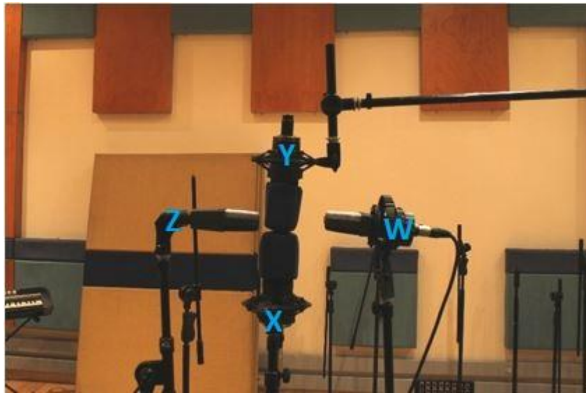
Figura 26. Arreglo de micrófonos técnica Nimbus Halliday, Imagen propia
