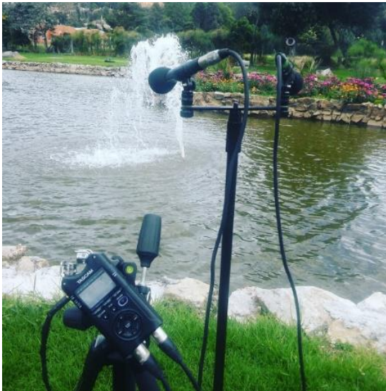
Figura 31. Grabación de estanque Universidad San Buenaventura con la técnica de microfoneo estero AB, Imagen propia
