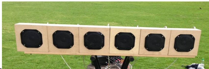
Imagen 7: Producto final del diseño del arreglo lineal WFS
