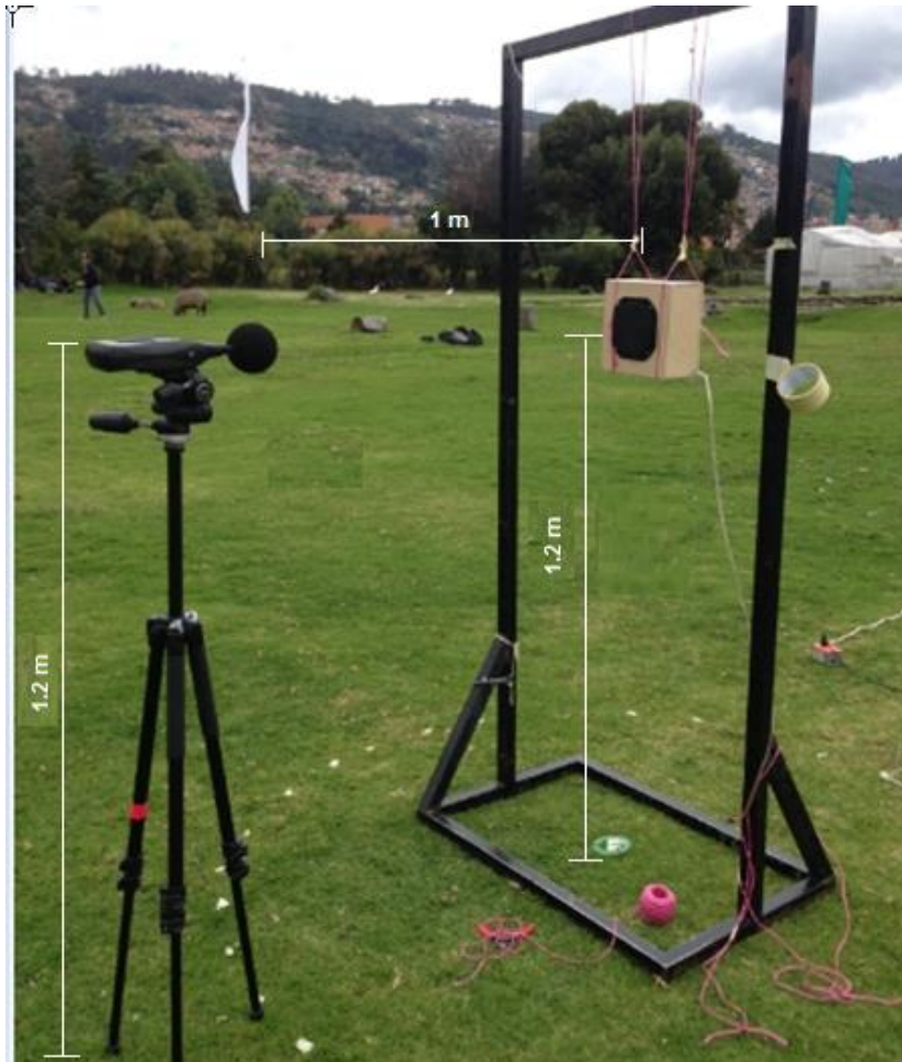
Imagen 2: Montaje de la medición de sensibilidad de una caja
