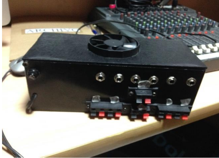
Imagen 4: Amplificador con entradas de línea y de potencia de audio del amplificador.
