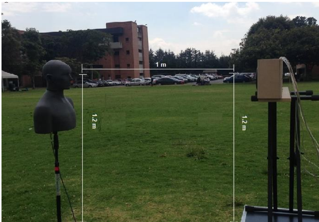
Imagen 13: Montaje de la medición de la diferencia Interaural de Intensidad y Tiempo
