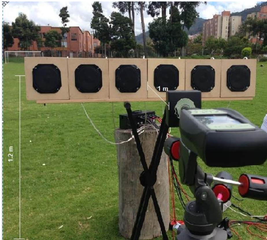
Imagen 3: Montaje de la medición de sensibilidad del arreglo lineal
