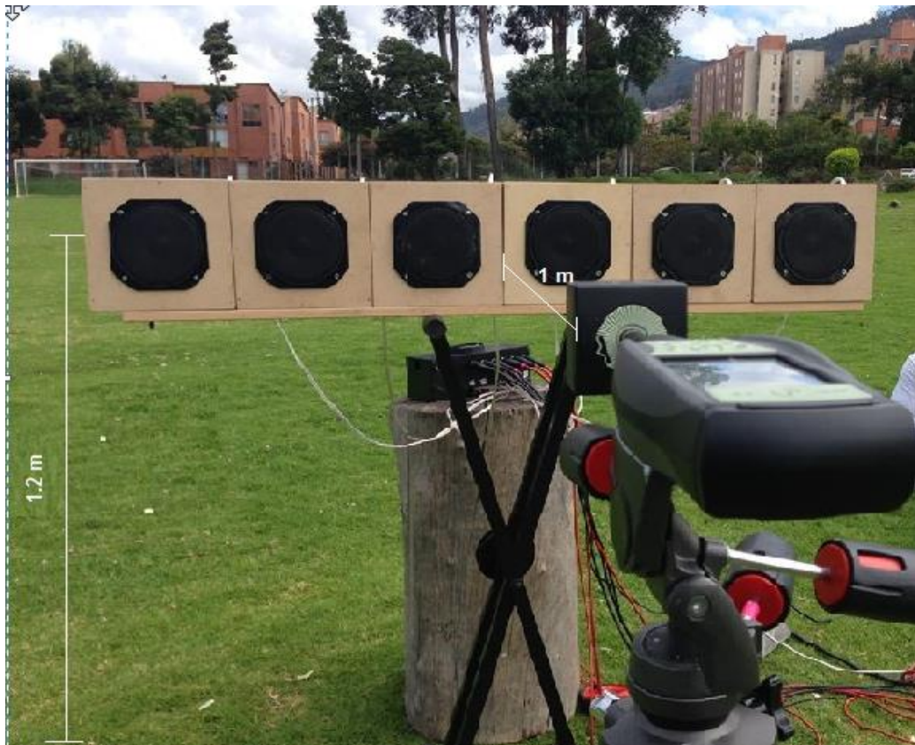
Imagen 13: Montaje de la medición de la directividad del arreglo lineal
