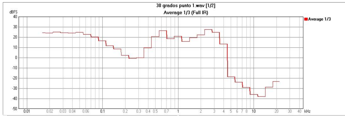
Gráfica 3: Promedio de la señal de barrido logartímico senoidal (Log Sine Sweep)
