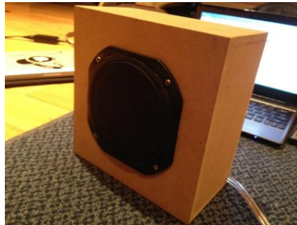
Imagen 7: Producto final del diseño del arreglo lineal WFS
