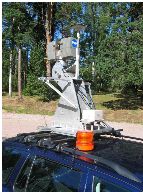
Kuva 19. MLS-keilain (FGI-roamer) auton katolle asennettuna. Kuvan ©Antero Kukko (FGI).
