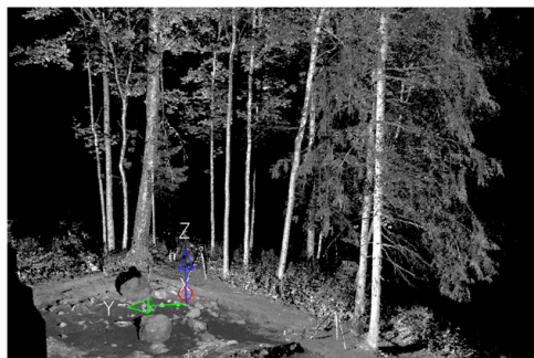
Kuva 18. TLS-mittauksen tuottamaa intensiteettikuvaa puustosta (Seurasaaari). Kuvan ©Matti Vaaja & Hannu Hyypä.
