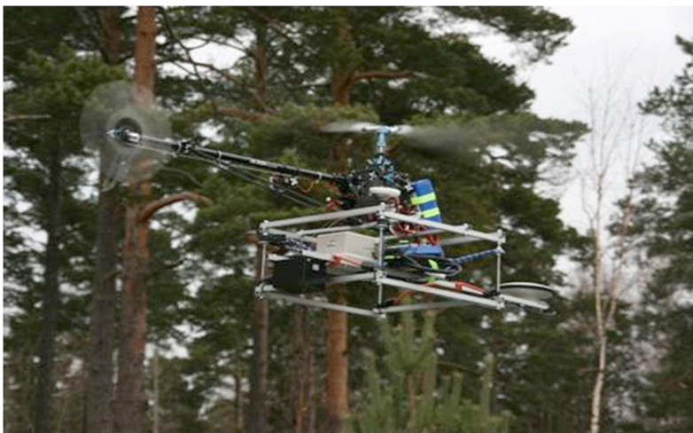
K u v a 2 6 . Lennokkiin (Unmanned Aerial Vehicle, UAV) sijoitettu laserkeilain. Kuvan © Anttoni Jaakkola /Juha Hyypä (FGI).
