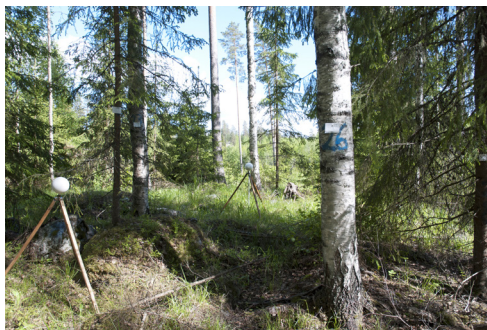
Kuva 20. Referenssipalloja, joiden avulla useampi keilaus voidaan liittää toisiinsa. Kuvan ©Ville Kankare.
