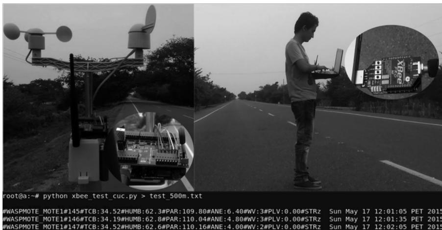
Figura 10. Imágenes tomadas durante la prueba de campo. En la parte izquierda la estación meteorológica, a la derecha el nodo coordinador.
