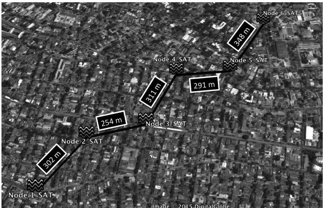
Figura 6. Distancia entre nodos para el sistema de monitoreo en arroyo “La Brigada”.
