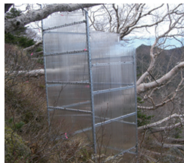
図1：温暖化実験 (周囲より高温にして植物への影響を調べる)
