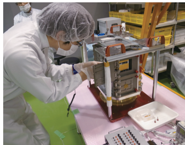
図1: 超小型衛星(結)の装填
