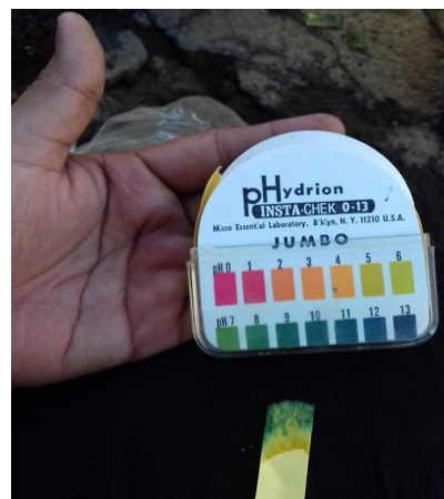
Resultado de la prueba del PH del suelo, PH 7. Fuente propia
