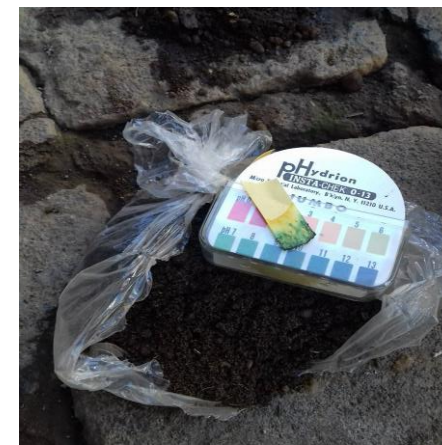
Resultado de la prueba del PH del suelo, PH 7. Fuente propia
