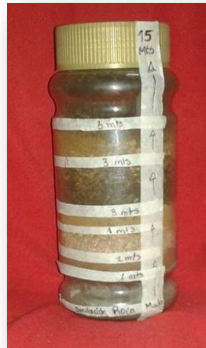
Muestra de perfil de suelo, con medidas Proporcionales a los 15 mts de altura real fotografía 6 Fuente propia
