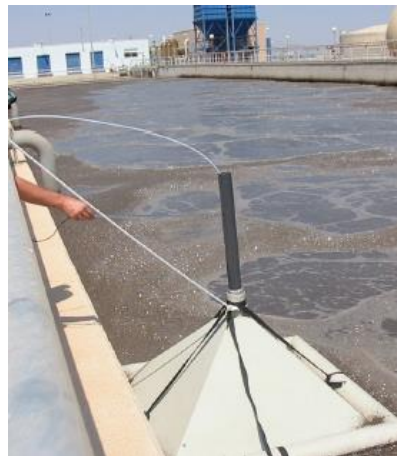
Figura 5.1.2.3. Campana de muestreo para fuentes difusas aireadas.
