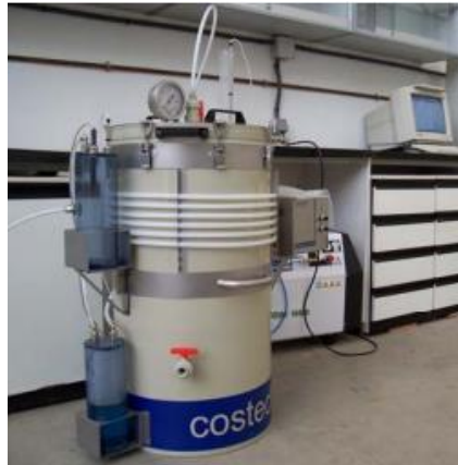
Figura 5.3.1. Equipo de respirometría dinámica en fase sólida con PC de control y módulos de acondicionamiento de señal. (Respirometer 3022).
