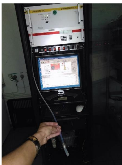
Figura 5.4.1. Cromatógrafo de gases (Chroma S).
