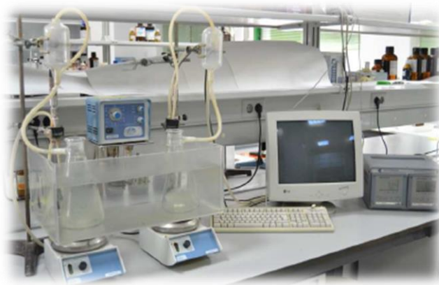
Figura 5.2.4. Equipo de respirometría con PC de control y módulos de acondicionamiento de señal.
