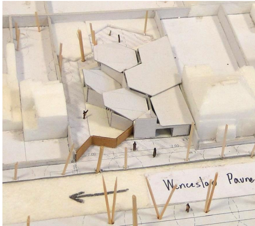
Fig. 3. Maqueta del proceso que evidencia la trama hexagonal y la forma escalonada.
