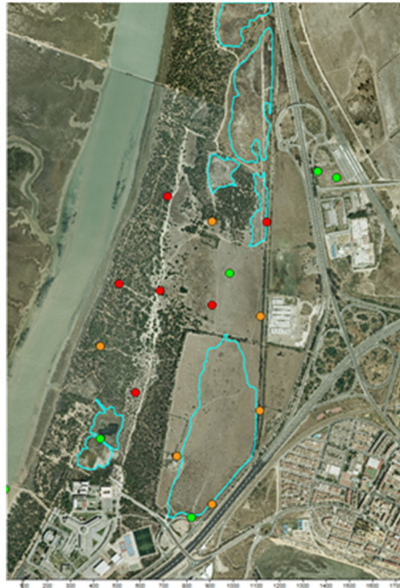
Figura 7: Fotografía aérea con la red de monitorización hidrológica implementada en el PM Los Toruños. Se señala en azul las áreas inundables, con círculos naranjas y rojos los piezómetros construidos (con o sin datalogger, respectivamente) y con círculos verdes otros puntos acuíferos.
