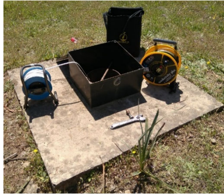
Figura 12: Hidronivel. Medición in situ de nivel en un pozo del acuífero de Benalup (Cuenca del río Barbate).
