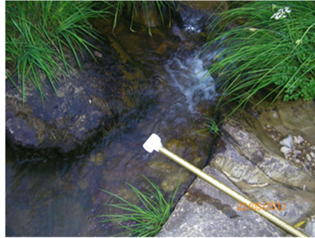
Figura 14: Micromolinete utilizado en río Guadares, principal aportación superficial al embalse de Montejaque (Málaga, España).
