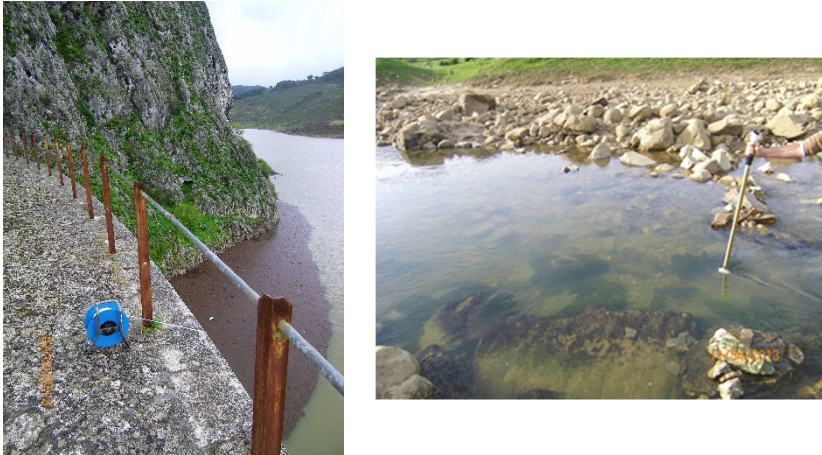
Figura 20: Izquierda: medida de nivel desde coronación de la presa. Derecha: medida de caudal en río.
