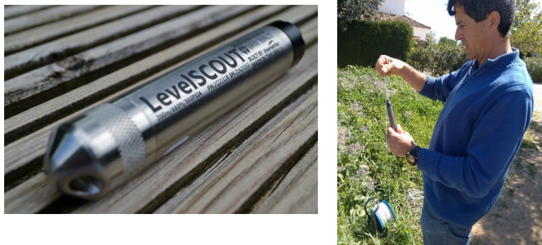
Figura 11: Izquierda: Datalogger marca LevelScout. Derecha: colocación de datalogger en el acuífero de Benalup (Cuenca del río Barbate).
