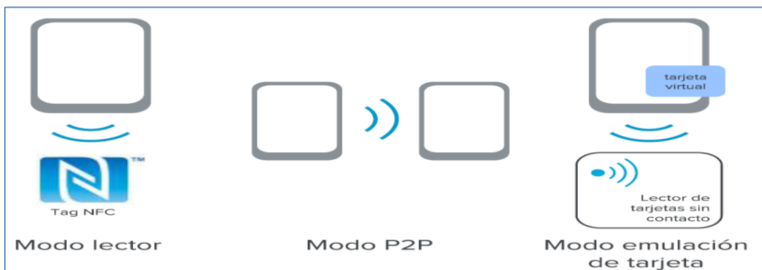
Gráfico 8. Modos de funcionamiento de la tecnología NFC
