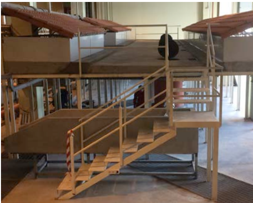
Figura 2. Modelo físico con simulador de lluvia a escala de barrio en el laboratorio de hidráulica del CITEEC.
