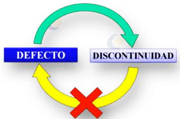
Figura 9: Relación entre defecto y discontinuidad.
