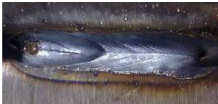
Figura 13: Punto de soldadura agrietado detectado durante la inspección visual previa a la soldadura [10]
