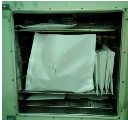
Figura 7. Estufa con sobres individuais e numerados cos rametos de C. edulis no seu interior para secaren e quedarmos soamente coa masa vexetal.
