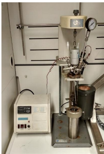
Figura 3.3: Fotografía del montaje empleado para los tratamientos de autohidrólisis.
