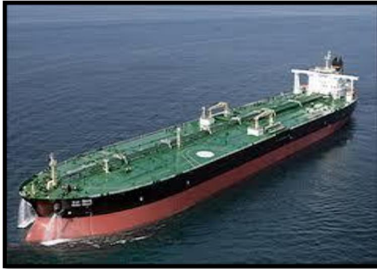
Actualmente casi todos los petroleros en construcción son del tipo de doble casco, en detrimento de los más antiguos diseños de un solo casco (monocasco), debido a que son menos sensibles a sufrir daños y provocar vertidos en accidentes de colisión con otros buques o encallamiento.
