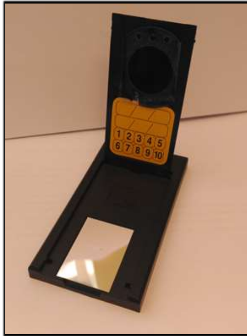
Figura 7-3 Detector de trazas de radón (3 meses).
