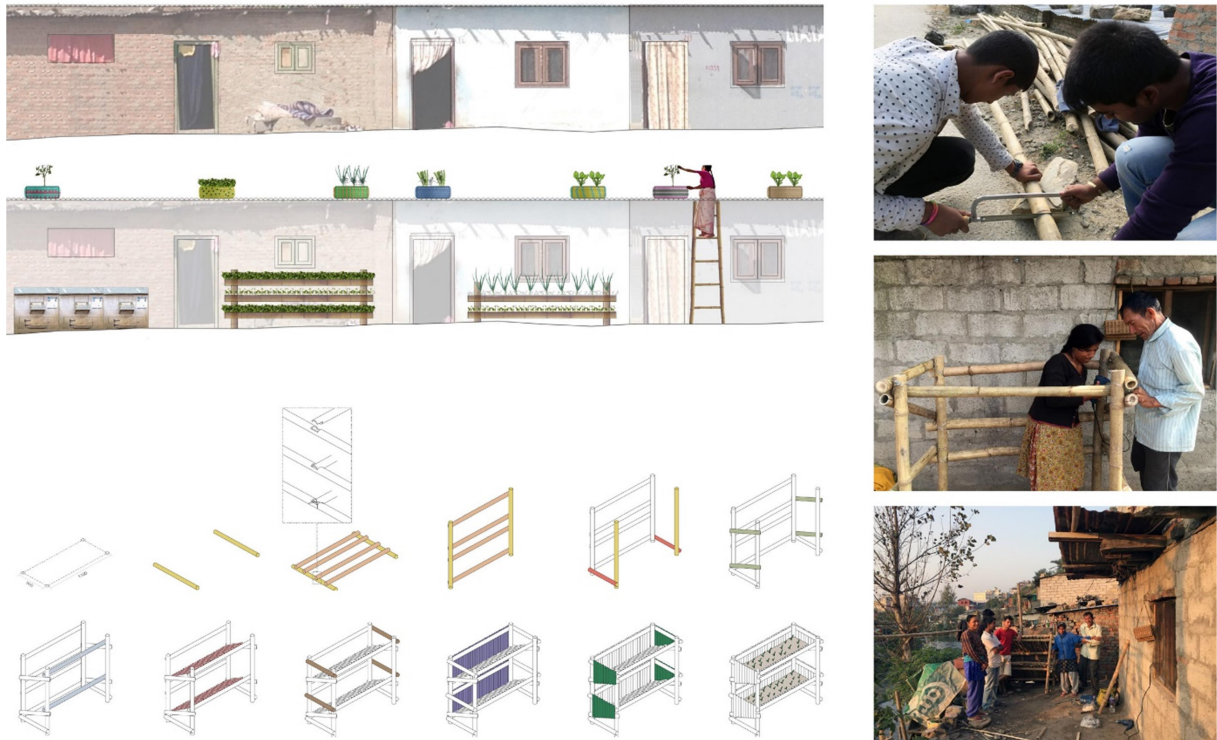
8. Muros y cubiertas comestibles. Maceteros de bambú: propuesta, resumen del manual de construcción e imágenes del proceso constructivo en el asentamiento informal de Gari Gaun.
