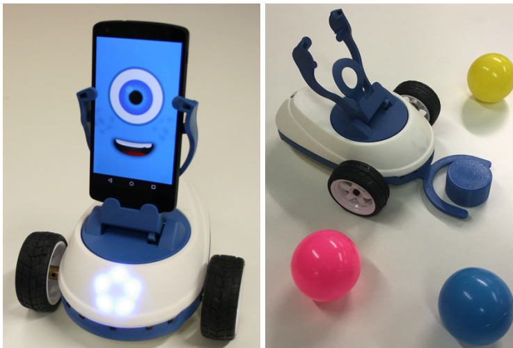
Figura. 1. Robobo con el Smartphone conectado (izquierda). La base móvil con un empujador impreso en 3D (derecha)
