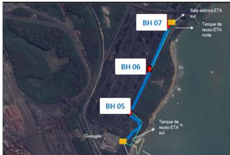
Figura 12 - Vista superior das Barreiras Hidráulicas (BHs) localizadas em Praia Mole
