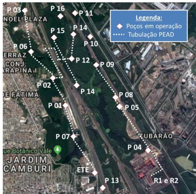
Figura 10 - Vista superior da localização dos Poços profundos da Unidade de Tubarão
