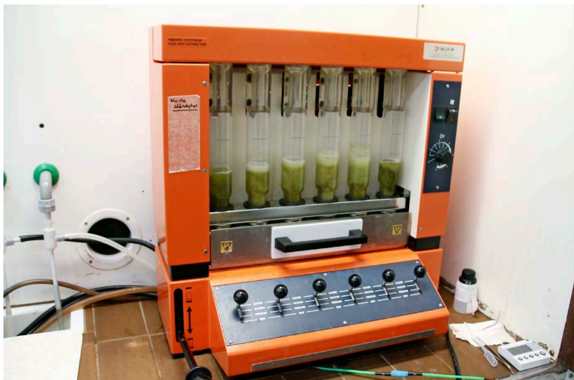
Karkearehujen kuidun referenssimäärittämenetelmässä näytteitä keitetään yksi tunti saippualliuksessa.
