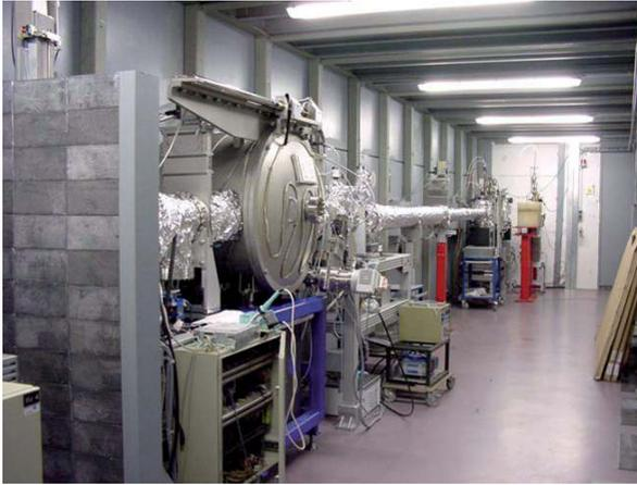
Abb. 5 Messaufbau der synchrotronbasierten Röntgenfluoreszenzanalyse (Sy-RFA).
