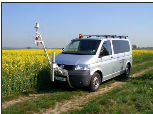
Abbildung 5: Meteorologische Messtechnik an der Fahrzeugfront
