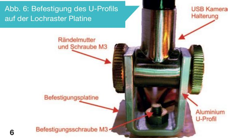
Abb. 6: Befestigung des U-Profiles auf der Lochraster Platine
