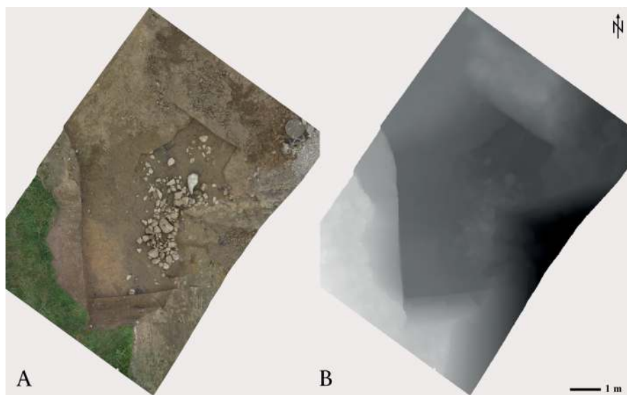
Abb. 4 In eine CAD- oder GIS-Umgebung einbindbare Rasterdaten am Beispiel Cham-Grindel ZG, Schweiz. A: georeferenziertes und damit genordetes lagegetreues Orthophoto. B: Digitales Oberflächenmodell (DOM) in Graustufen von schwarz = 421,8 bis weiß = 425,59 m ü. M.
