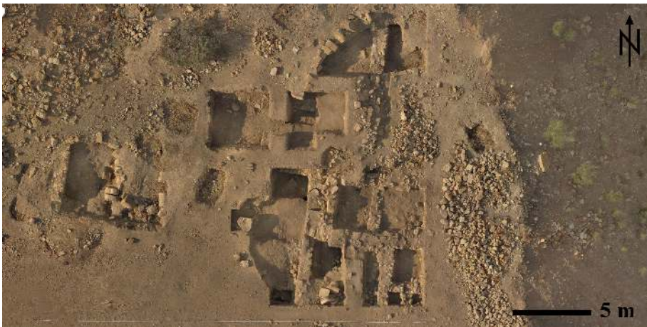
Abb. 12 Terrasse 1 des Tall adh-Dhahab el-Gharbiyeh, Jordanien, mit partiell freigelegten spätantiken Baustrukturen: Orthophoto mit einer Texturauflösung von deutlich unter 1 cm, am unteren Bildrand markiert ein Maßband die West-Ost-Hauptmessachse.
