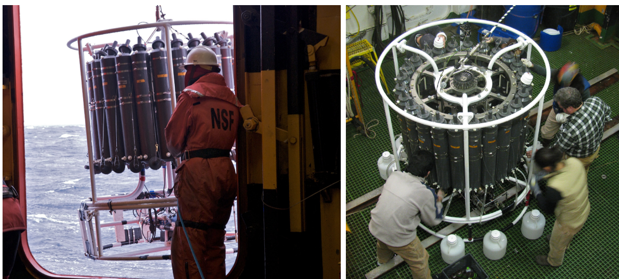
Figura 2.3. Maniobras de muestreo empleando una roseta-CTD equipada con 24 botellas Niskin de 8,5 litros cada una. Fotografías cortesía de Debbie Nail Meyer.
