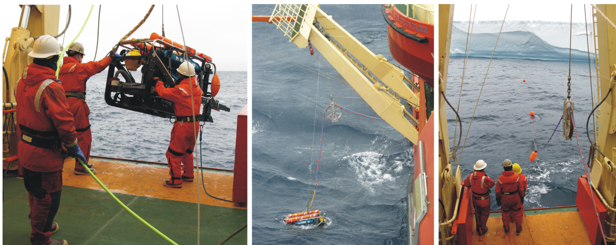
Figura 2.2. Maniobras de muestreo empleando un vehículo submarino operado a control remoto (ROV-Phantom S 2).
