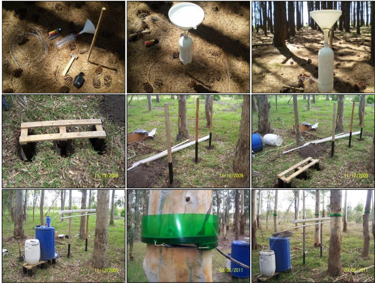
Figura II.14. Secuencia de imágenes mostrando el instrumental de fabricación y distintos pluviómetros instalados bajo la canopea forestal.
