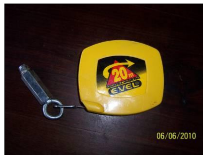
Figura IV.5. Cinta métrica adaptada para medición de los niveles de capa freática.
