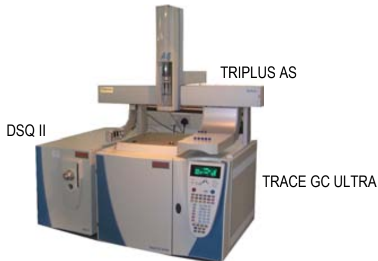
Figura 8. Cromatògraf de gasos TRACE GC ULTRA amb l'espectròmetre de masses DSQ II i l'automostrejador TRIPLUS AS de ThermoFisher Scientific
