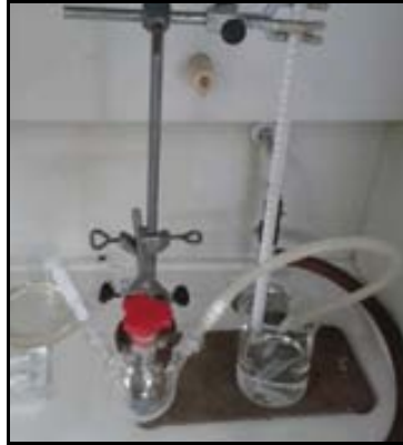
Figura 16. Muntatge experimental d'un calcímetre
