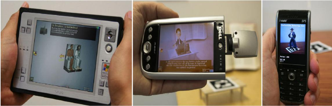
**Fig. 52** Dispositivos de mano (hand-held) UMPC, PDA y Smartphone, que utilizan las librerías ARToolkitPlus. UMPC En D. Wagner & Dieter Schmalstieg (2007)
