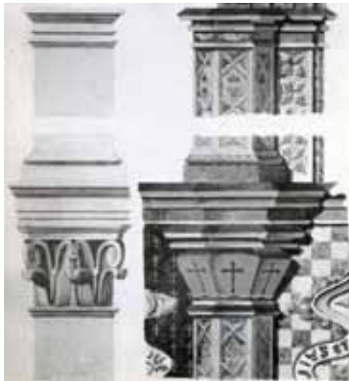
Fig. 4. Alçat interior i secció del cambril existent, dibuixades per Villar; representen el projecte construït per Cellés. A sota, noves motllures dissenyades per Villar comparades amb les existents; i, a l'esquerra, l'interior de l'església abans de la destrucció en el gravat de Laborde (Altés, 1992: làmines).
