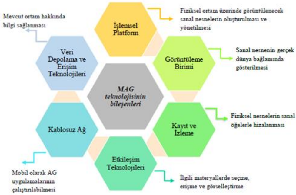
Şekil 2.4 MAG Teknolojisi İçin Gerekli Olan Bileşenler (Höllerer and Feiner 2004, Krevelen and Poelman 2010)
