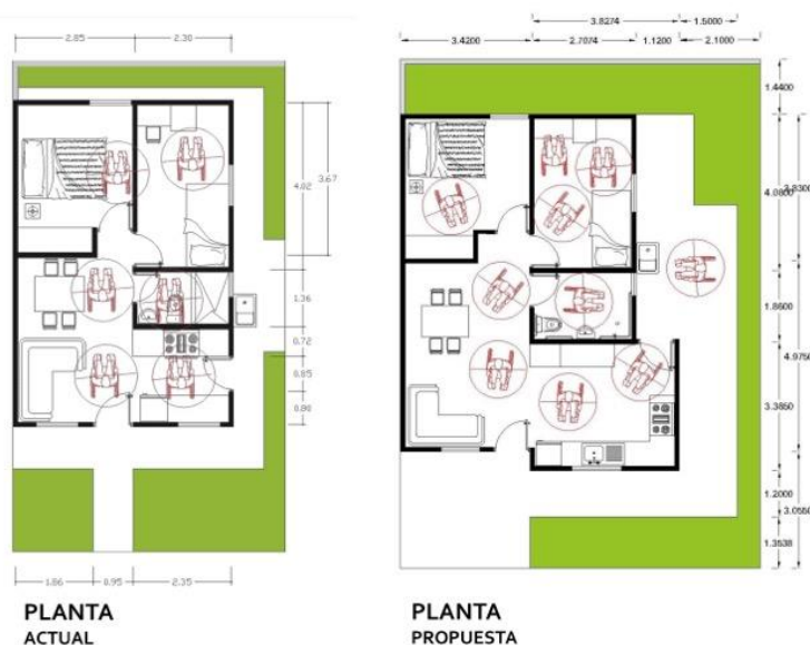
Figura 6. Planta actual y rediseñada de la vivienda T43 en el fraccionamiento Praderas de Oriente, en Juárez
