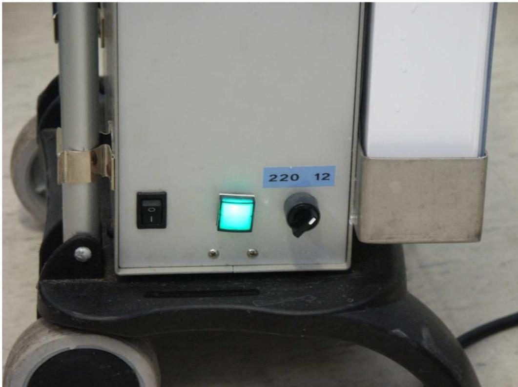
**SDTA. Visión lateral. Sistema de apertura de la aspiración (izquierda); Sistema de elección de la fuente de alimentación 220V/12V (derecha).**
