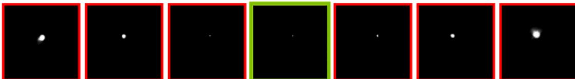
Fig. 5.3.2 Capturas correspondientes al proceso de enfoque del objetivo mediante una fuente láser. La captura resaltada en verde registrada mediante la herramienta "Image acquisition" de Matlab [MATLAB 2011] corresponde al menor tamaño de imagen. En esta posición, el sensor CMOS se sitúa en el plano focal del objetivo gran angular. [McMenemy 2003]
