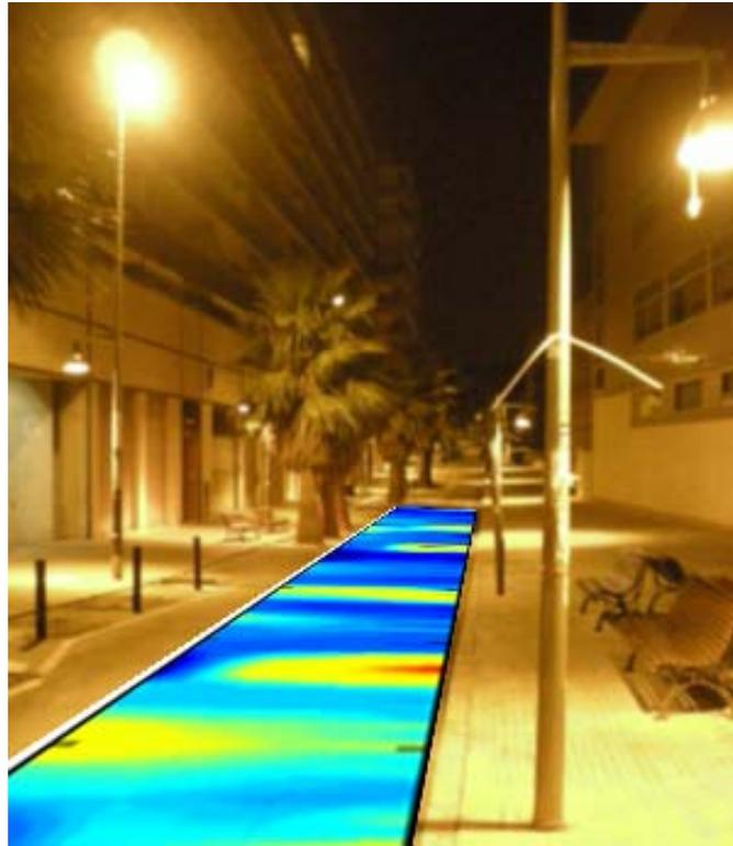
Fig 5.4.17 Representación virtual de un mapa de iluminación en la calle Miquel Vives de Terrassa. La imagen muestra cómo las fuentes de luz producen una iluminación con poca uniformidad a lo largo de toda la calzada medida.
