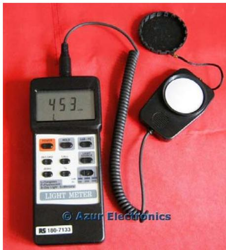
Fig. 5.1.1 Luxómetro empleado en las medidas experimentales. [RS 2010]
