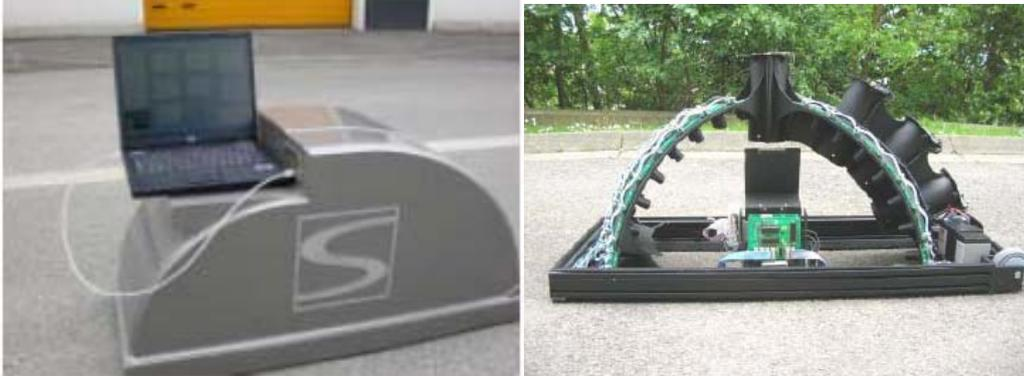
Figura 3.3.8. Muestra de un equipo fotométrico combinado; en la imagen de la izquierda se puede ver el chasis del equipo con su salida de datos hacia un ordenador portátil. En la imagen de la derecha, se muestra al equipo sin el chasis protector donde se pueden advertir los distintos sensores con los que trabaja este equipo. [Jackett 2009]
