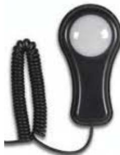
Figura 3.3.2. Cabeza fotométrica que dispone de un difusor protegido por una cápsula semiesférica. [Gossen 2012 a]
