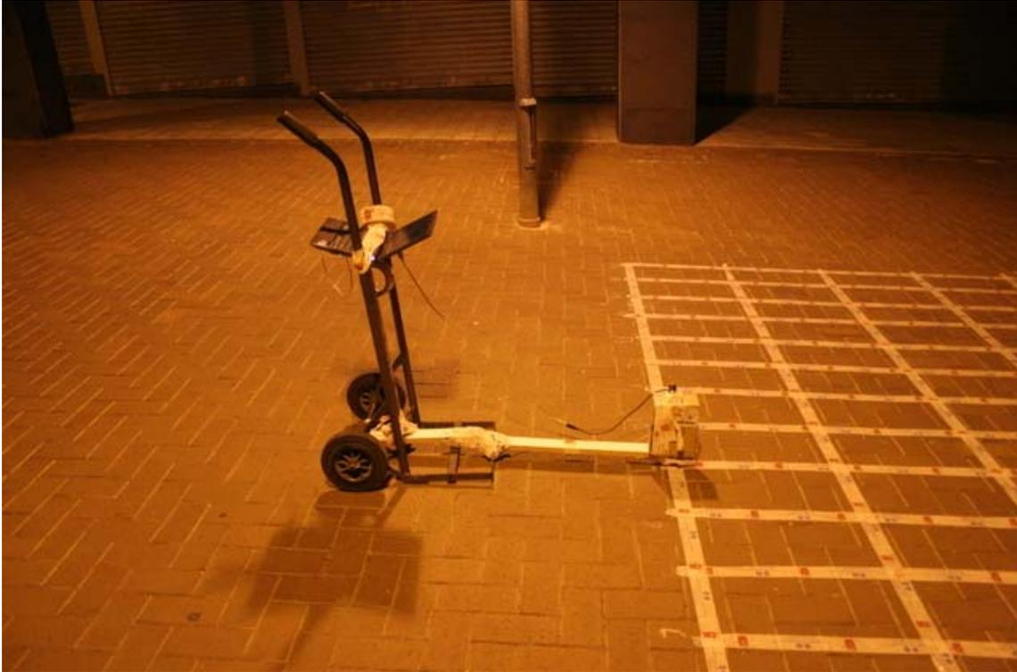
C.1.3 Elementos mecánicos utilizados para desplazar el luxómetro, el ordenador portátil y la cámara en todas y cada una de las posiciones de la cuadrícula.
