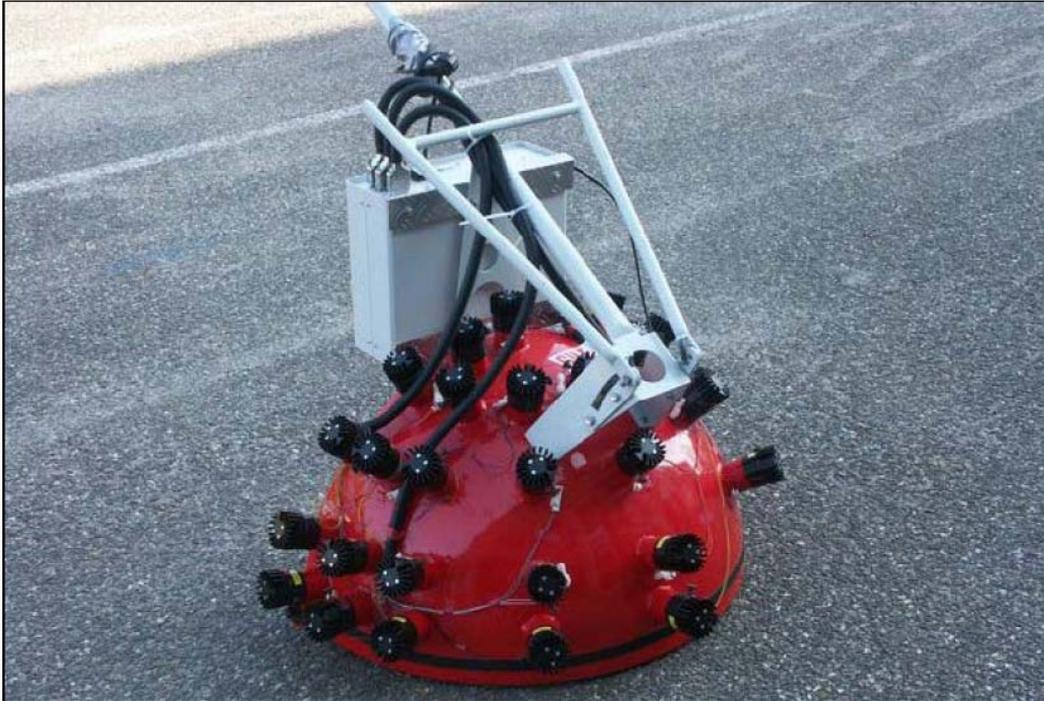
Figura 3.3.9. Ejemplo de un prototipo de dispositivos de medida fotométrico dinámico. El sistema evalúa la luminancia de las instalaciones de alumbrado público, como las carreteras así como el estado del pavimento mediante medidas de reflectometría de la luz sobre la superficie del asfalto. Este tipo de equipos es capaz de realizar hasta un centenar de medidas en pocos segundos. [Jackett 2009]
