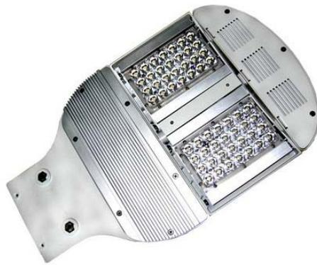
Figura 3.4.2. Lámpara de alumbrado público basada en tecnología LED. Las lámparas de este tipo llegan a tener entre 60 y 90 LEDs normalmente y pueden consumir unos 80W de potencia con una eficiencia base de 100lm/W. [b2b-linx 2012]
