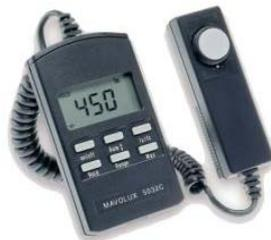
Figura 3.3.4. Luxómetro portátil. Los luxómetros portátiles presentan muy diversas calidades en lo que a su capacidad de medir se refiere. Se pueden llegar a encontrar dispositivos de este tipo con una relación de precio de hasta 5:1 en equipos portátiles. Algunos de ellos son muy notables para poder trabajar con ellos en las condiciones más exigentes. Los luxómetros portátiles de gama alta tienen salida de datos digital y tienen una respuesta más rápida que los de gama baja. [Gossen 2012 b]
