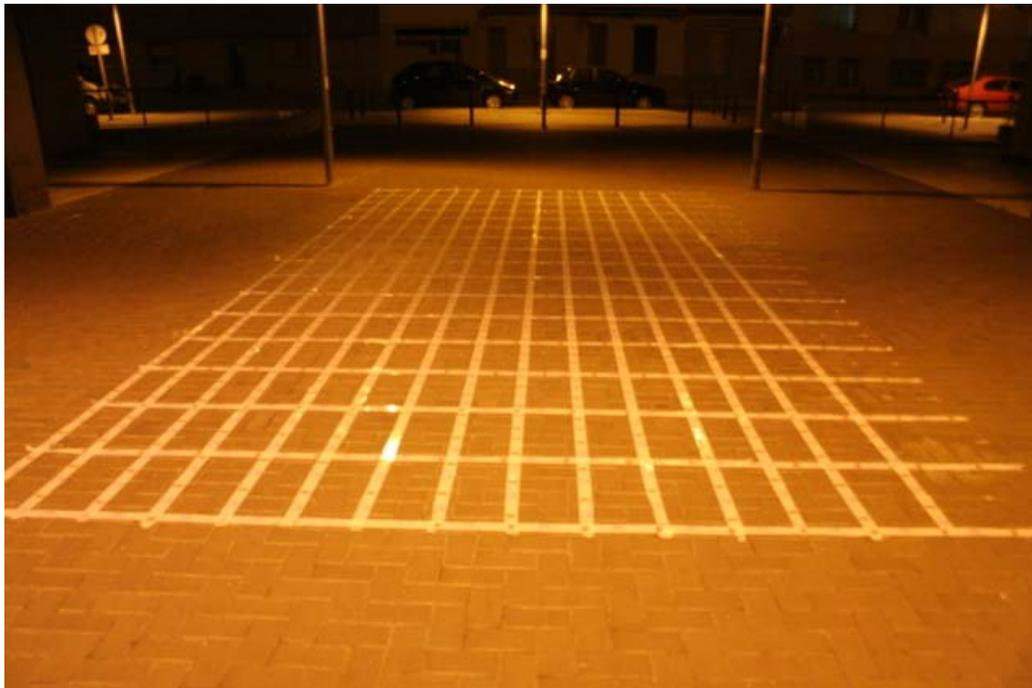
C.1.2 Detalle de la cuadrícula que marca las posiciones de medida en el plano de referencia y sitúa las posiciones x,y para la realización de las medidas en los planos de nodos P02 y P10, y el plano de referencia P0.
