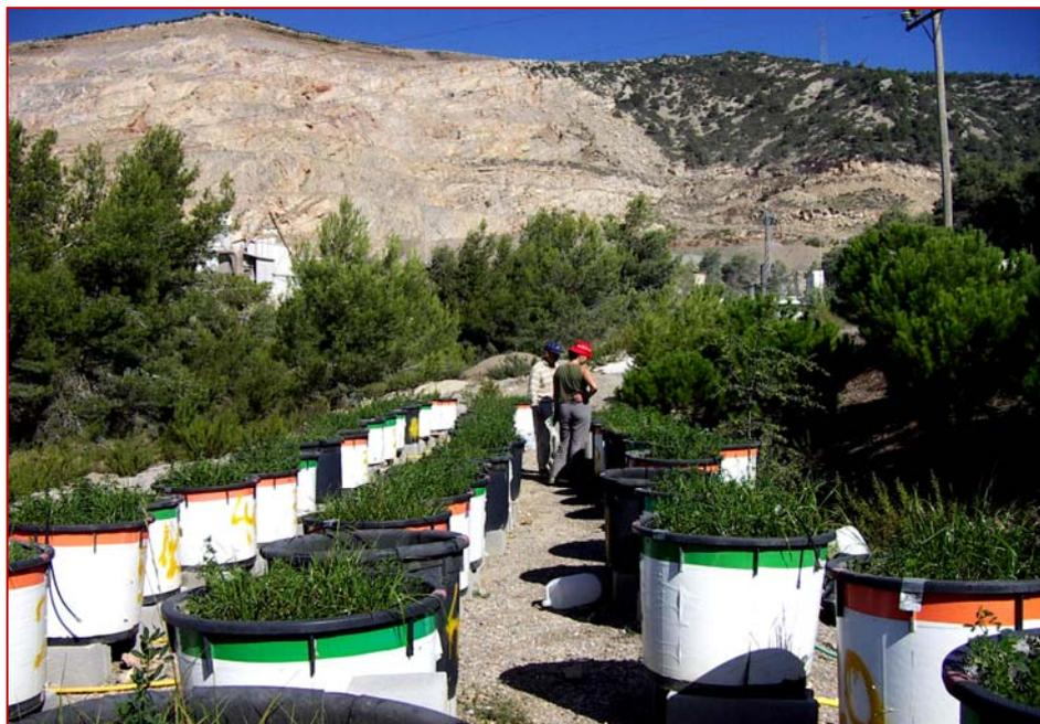
**Figura 4.6** Disposición de los lisímetros
