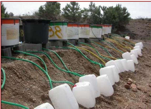
**Figura 4.5** Colectores del agua de drenaje.
