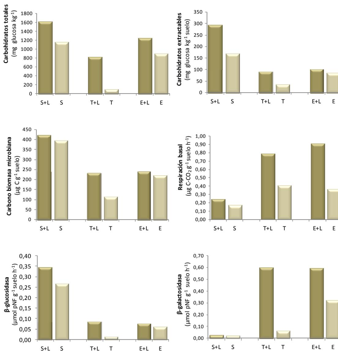
**Figura 5.5** Diferencias en los valores medios de los parámetros bioquímicos entre los suelos restaurados y los suelos control en los muestreos finales. L-S: mezcla lodos suelo RUBAU, S: suelo RUBAU sin enmienda; L-T: media de las mezclas lodos suelo residual de Trituración, T: suelo residual de Trituración; L-E: media de las mezclas lodos suelo residual de Extracción, E: suelo residual de Extracción.
