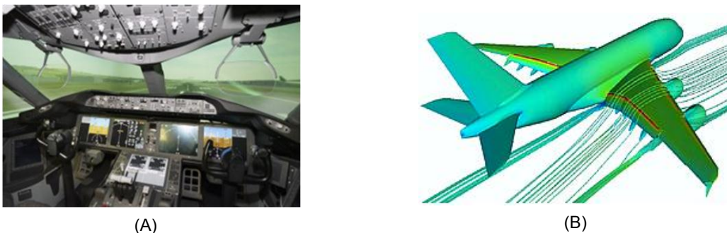
Fig. 5.2 (A) Modelo de una cabina de avión de un Simulador de vuelo (B) Modelo de simulación computacional de fluidos CFD ( Computational fluid dynamics ) para estudiar las ráfagas de viento durante un vuelo. Fuente: http://www.aterrizajes.net - Southwest Research Institute
