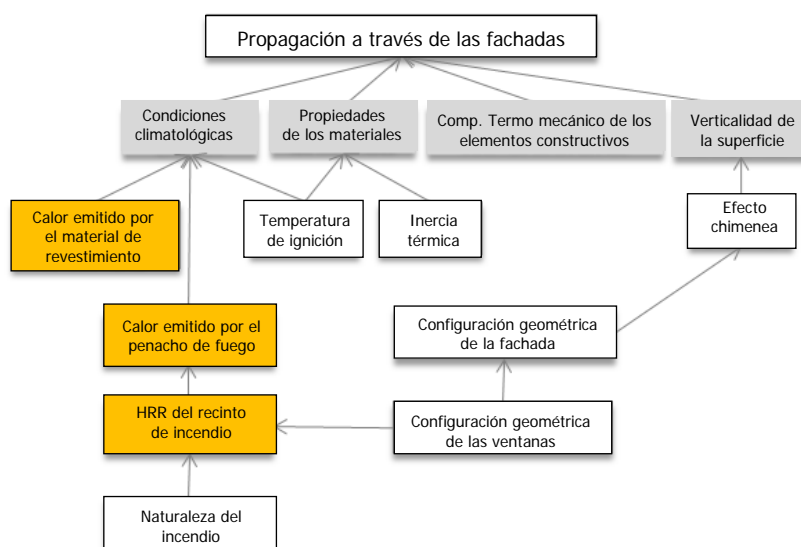
Fig. 4.17. Esquema de los factores que inciden en la propagación del fuego a través de las fachadas. Fuente: elaboración propia basada en un esquema propuesto por Wade, 1995
