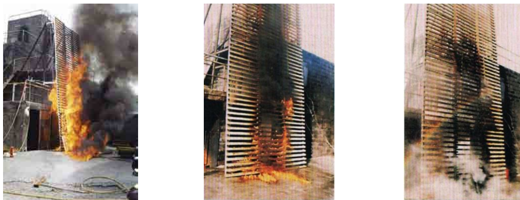
Fig. 3.61 Imágenes del ensayo realizado para probar la efectividad del sistema de extinción.
