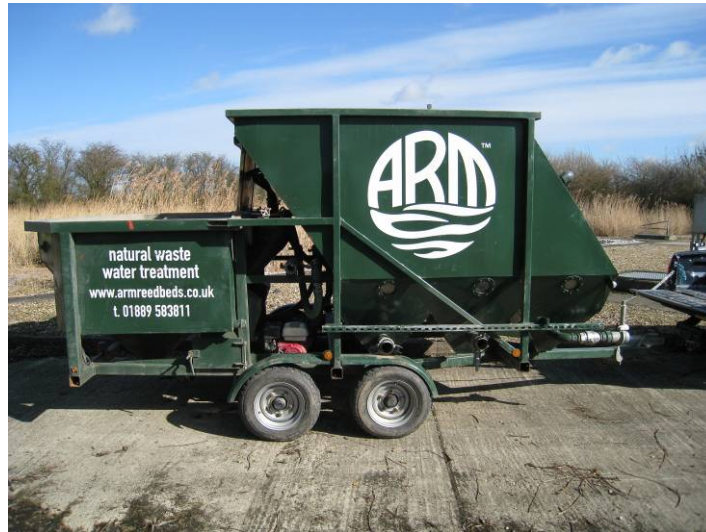
Figura 1.14 Máquina lavadora de grava (ARM Ltd.).
