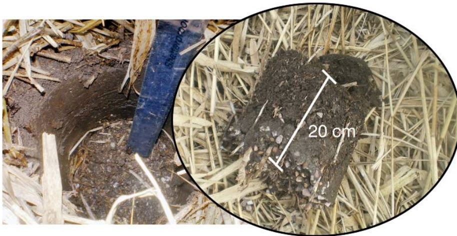
Figura 1.9 Testigo extraído de los 20 cm superficiales a la entrada de un humedal de flujo subsuperficial horizontal. Nótese la capa superficial de lodo que impide la infiltración.
