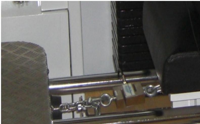
Figura 28: Cadena con célula de carga MuscleLab acoplada.
