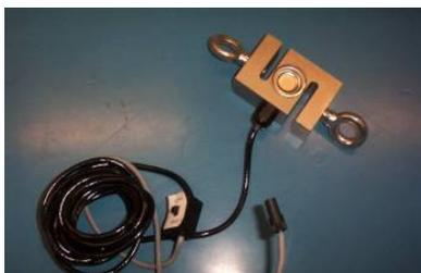
Figura 9: Célula de carga del MuscleLab.
