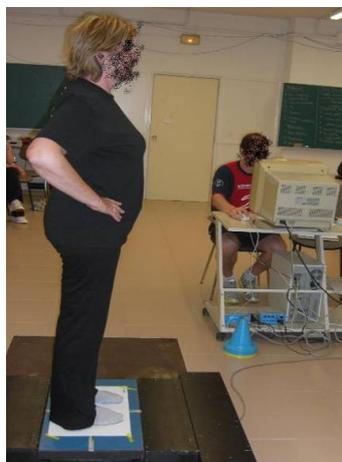
Plataforma de fuerza Dinascan/IBV (Instituto de Biomecánica de Valencia) de 600x370 mm de área activa, 100mm de altura y de 25 Kg de peso para valoración del área desplazamiento del CdP y velocidad de desplazamiento del CdP.
