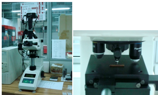
Figura II-20 Microindentador Wilson Wolpert (Micro-Knoop 401 MAV) (esquerra) i detall de la mesura de la microdureza d'un material termoestable (dreta)
