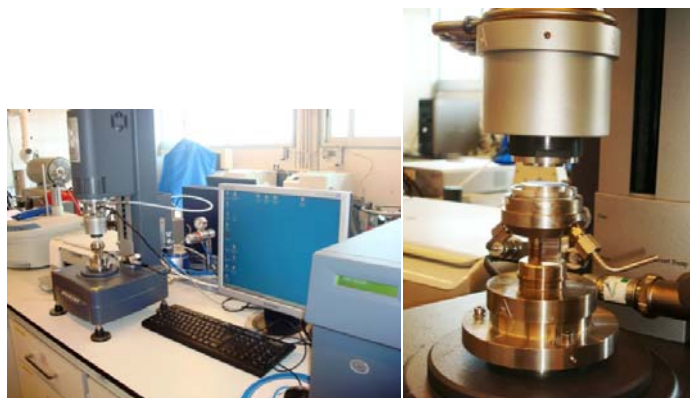
Figura II-9 Reòmetre ARG2 de TA instruments (esquerra) i detall dels plats paral·lels entre els quals es col·loca la mostra (dreta)
