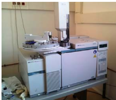
Figura II-14 Cromatògraf de gasos 6890 equipat amb un espectròmetre de masses 5973 (GC-MS)
