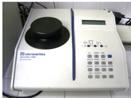
Figura II-12 Picnòmetre d'heli AccuPyc 1330 emprat
