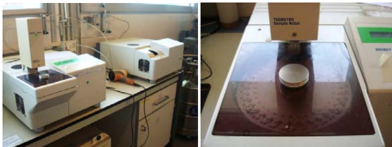
Figura II-1 Calorímetres DSC821e i DSC822e (esquerra) i detall del braç robòtic TSO801RO del DSC821e (dreta)
