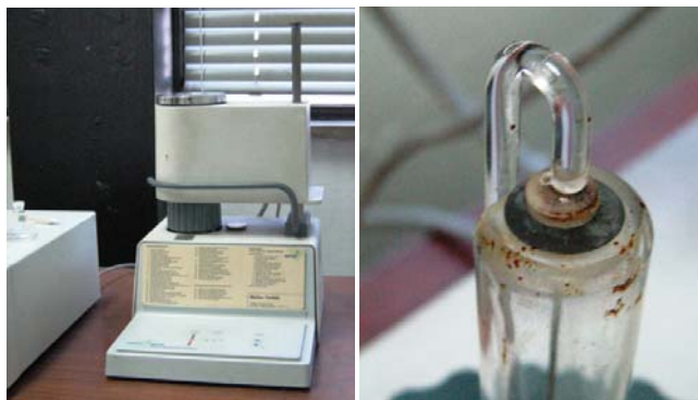
Figura II-5 Analitzador Mettler TMA 40 (esquerra) i detall de la sonda amb una mostra suportada en fibra de vidre entre dos discs de quars (dreta)
