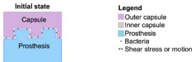
Modèle morpho-mécanique de la texture d'un implant mammaire [2]
