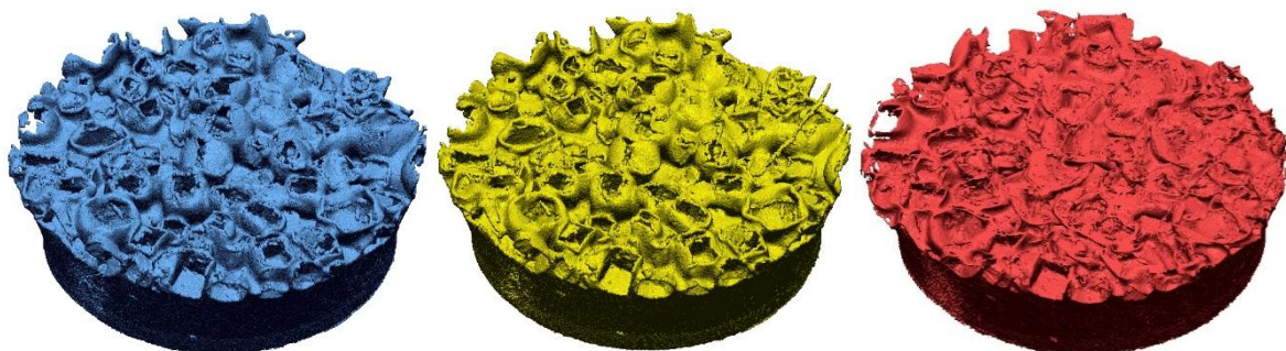
Morphologies d'une macro-texture sous cisaillement à 45° (de gauche à droite : essai 1, essai 2 et essai 4)
