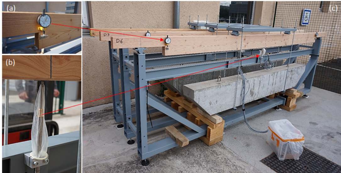
FIGURE 2 – Comparateur (a) ; Capteur LVDT (b) ; Poutres en fluage (c)
