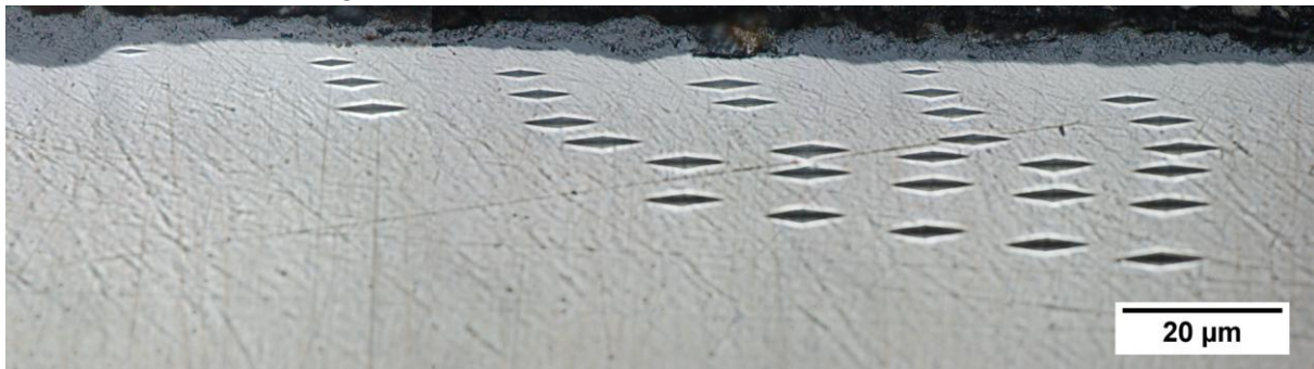
Figure 4 : Microscopie optique (grandissement x100), observation des indents KNOOP mettant en évidence le gradient de dureté sur une éprouvette M11 vieillie 130h à 600°C sous air .
