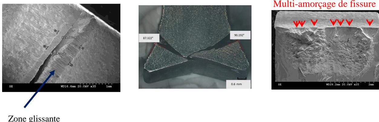
Figure 2.5 : faciès de rupture de l'éprouvette queue d'aronde après  $10^6$  cycles.
