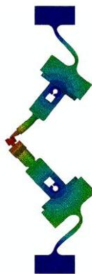
Figure 2.4 : déformée modal du 5<sup>ème</sup> mode du banc PREMECCY utilisé pour les essais. La fréquence est de 331 Hz.
