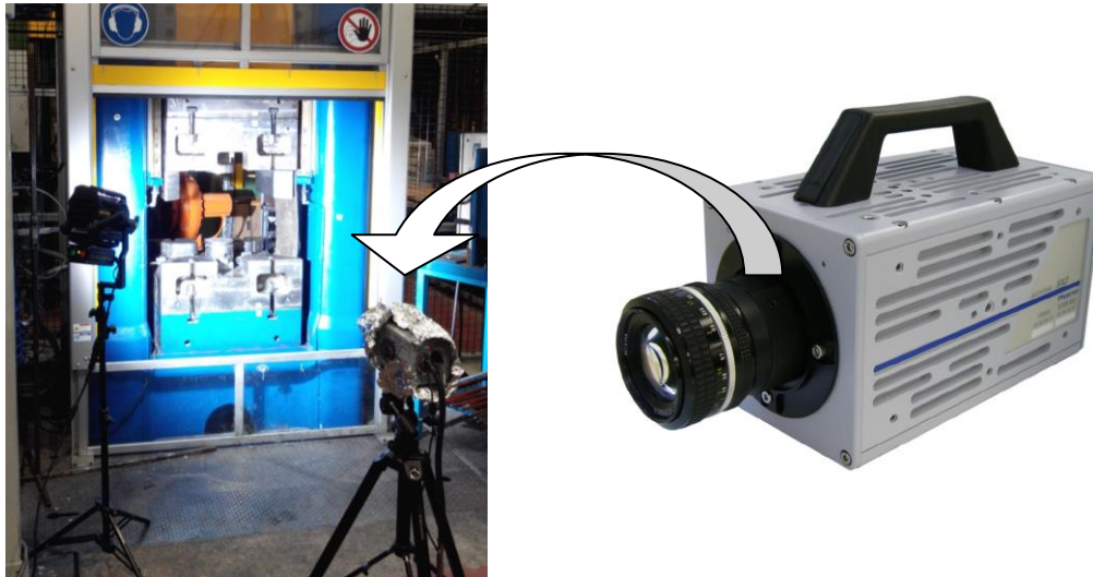
Figure 10 : Installation de la caméra rapide et du projecteur face à la presse
