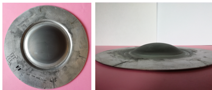
FIGURE 5 – Flan après l'essai d'expansion de la figure 4.
