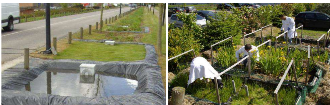
Figure 2 : Sites expérimentaux. A gauche : noue de voirie expérimentale. A droite : mésocosmes contaminés.
