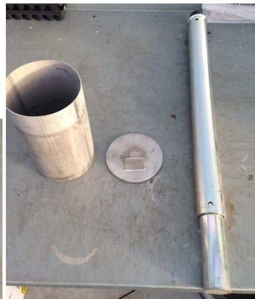
Figure 2. Matériel nécessaire : cylindre (gauche), plaque de 7mm d'épaisseur (milieu), Proctor (droite)
