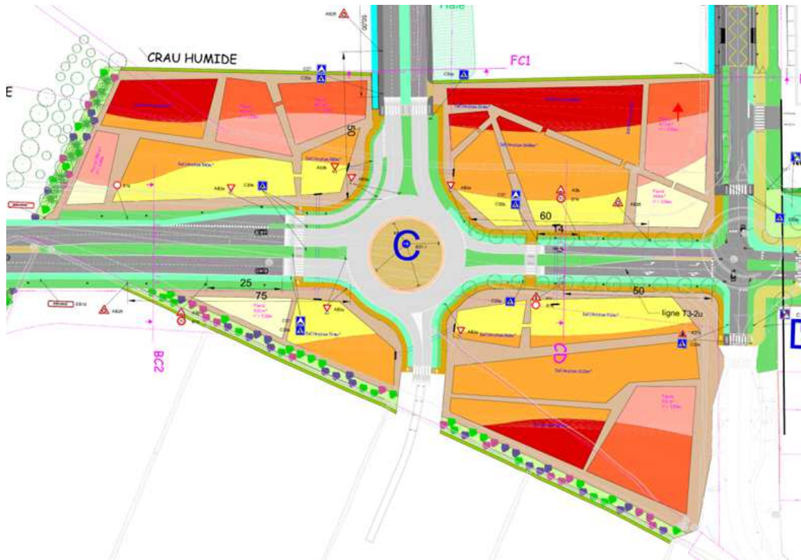
Remplissage des bassins méditerranéens progressif en fonction de la récurrence de l'évènement pluvieux
