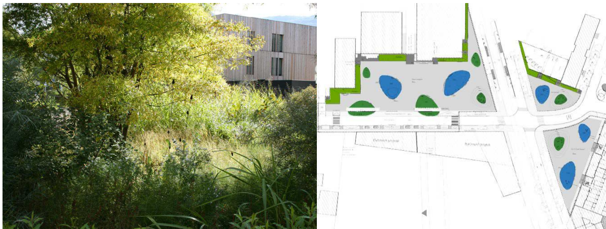
Collecte des eaux pluviales. Seuls les îlots marqués en bleu collectent les eaux des surfaces piétonnes, ils sont constitué d'une végétation à large spectre hygrométrique
