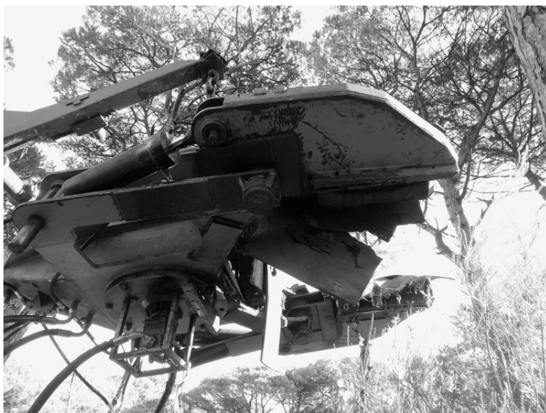
Photo 13 : Le mouvement de la « tête secoueuse » est créé par deux masses mises en rotation en sens inverse. Photo J.-M.C.
