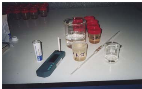
Fig 4.9. Determinació analítica de nitrats a l'aigua amb Nitratecheck
